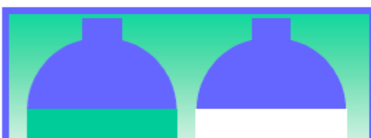
Esempio di vecchia e nuova colorazione distintiva per bombole contenenti protossido di azoto.
